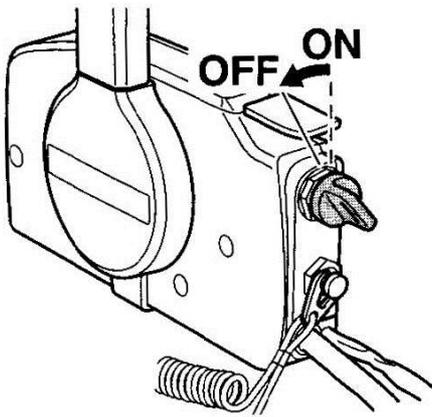
2. 若船外发动机装有燃油接头，发动机停滞
