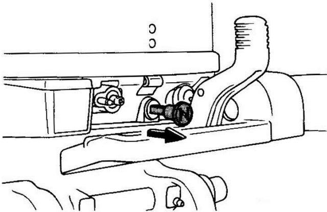
6. 将紧急起动拉索节端插入飞轮槽口,并将拉索在飞轮上顺时针缠绕数圈。
