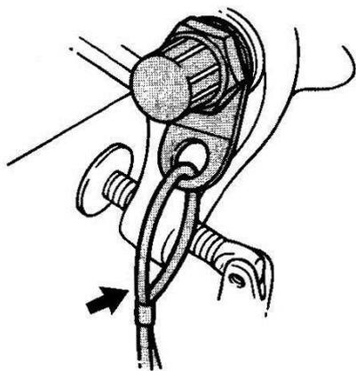
3. 用船外发动机随附的螺栓（如包装）将夹紧托架固定至船艙。具体操作请咨询您的经销商。**警告！不要使用发动机包装以外的螺栓、螺母或垫圈。如果要使用，它们必须至少具有相同的材质和强度，且完全拧紧。在拧紧以后，试运行发动机，检查它们是否拧紧。**
