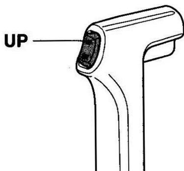
3. 若要将船外发动机恢复至正常的运行位置，按下电动倾角和倾斜开关，慢慢向下倾斜船外发动机。
