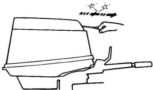
6. 在启动发动机后，缓慢地将手动起动机手柄恢复至初始位置并释放。
