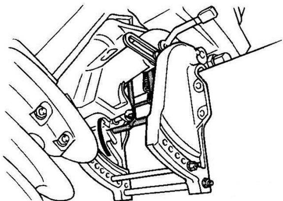
3. 如果装有倾斜支撑钮：将倾斜支撑钮拉出，慢慢将发动机向下倾斜。
