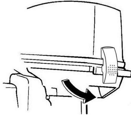
安装后，用双手推动顶罩，检查顶罩的连接件状况。如果顶罩松动，则由分销商进行修理。
