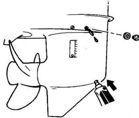
6. 在油位孔塞上安装新垫圈。当机油开始从油位塞孔流出时，插入并紧固油位孔塞。
