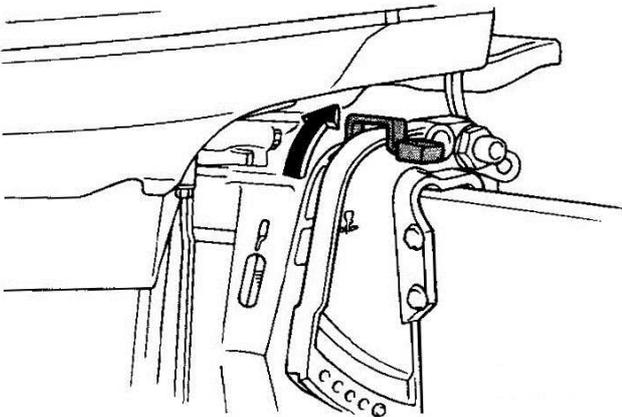
3. 将船外发动机略微向上倾斜。倾斜支撑托架将会自动锁定，从而在部分凸起位置支撑船外发动机。该船外发动机有 2 个位置适合于浅水航行。
