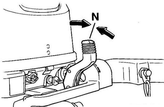
2. 断开船外发动机的燃油管线。
