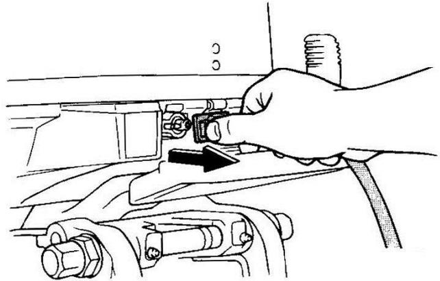
3. 拧紧燃油箱盖的排气螺钉（若有）。
