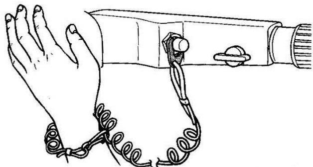
3. 将油门转把置于“START”（启动）位置。发动机启动后，将油门复置于全闭档。
