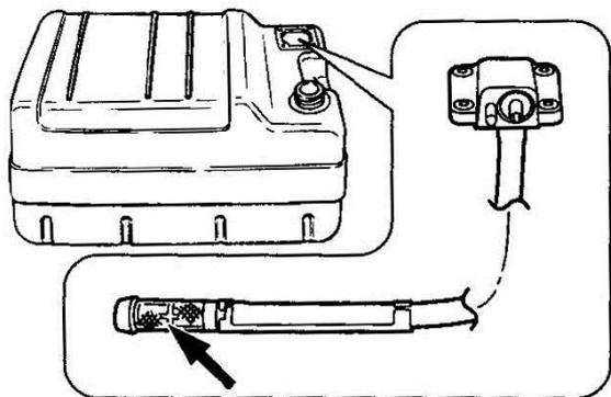
4. 在合适的清洁溶剂中清洗燃油滤清器（位于吸管的端部）并将其晾干。
